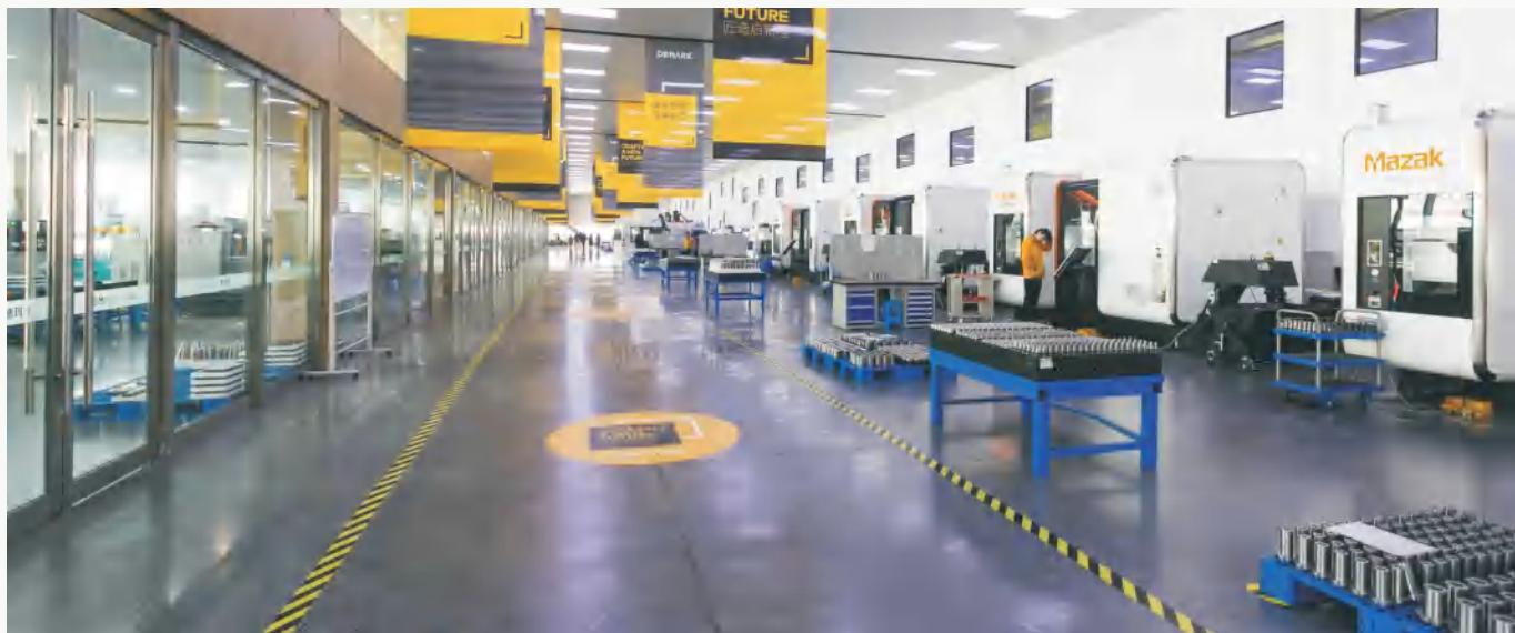
德玛克致力于打造世界级的恒温恒湿模具加工车间，保证材料在稳定的环境下满足严苛的精度标准。
